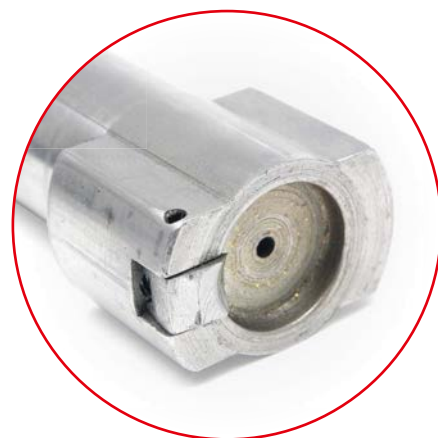
Rzut oka na czoło zamka ukazuje masywne rygle i wyciąg – ale za to w tym zamku nie ma żadnego wyrzutnika
