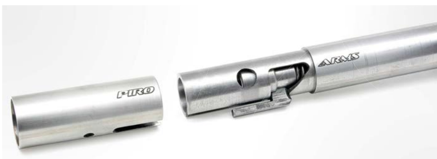
Demontaż tulei osłaniającej zameczek odsłania krzywkę napinającą iglicy wyciętą w trzonie – wszystko jak w normalnym zamku, tylko z powodu zamontowania dźwigni wstępnej ekstrakcji przesunięte w przód o kilka centymetrów
